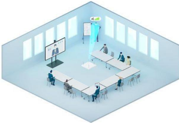
Die automatische, dynamische Beamforming-Technologie sorgt dafür, dass der aktive Sprecher gut hörbar ist – unabhängig davon, wo er sich befindet oder wie er sich im Raum bewegt
